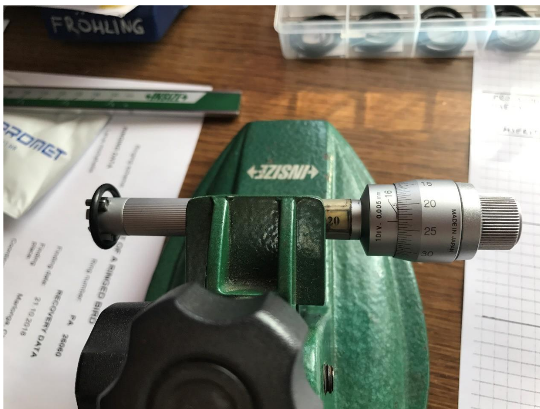
Slika 4.6. Primjer mjerenja unutarnjeg promjera O-prstena mikrometarskim vijkom
