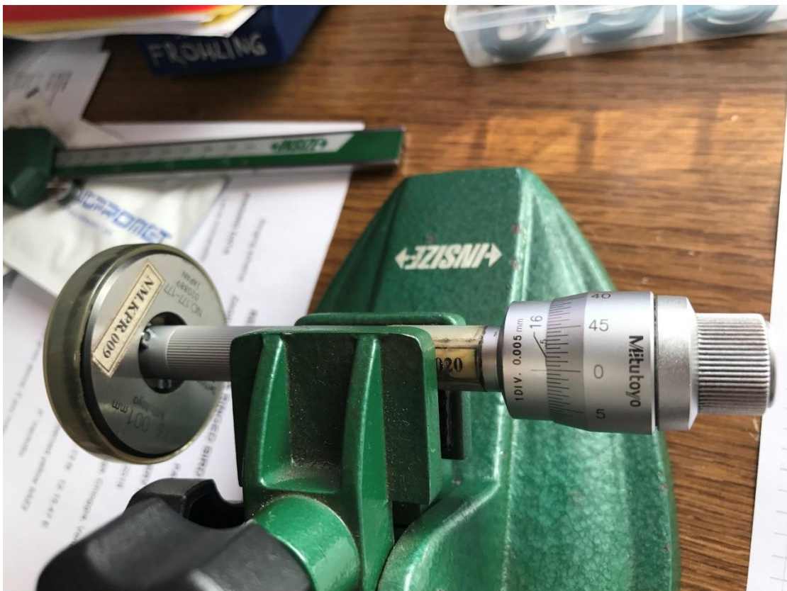
Slika 4.3. Kalibracija mikrometarskog vijka za unutrašnja mjerenja kontrolnim prstenom
