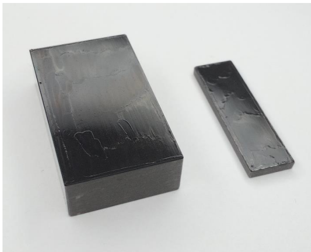
Slika 2.11. Etaloni 20 mm (lijevo) i 2 mm (desno) pripremljeni za kalibraciju sustava
