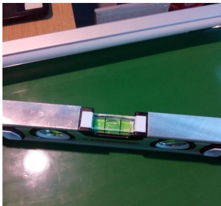
Slika 2.12. Provjera horizontalnosti pokretne trake libelom
