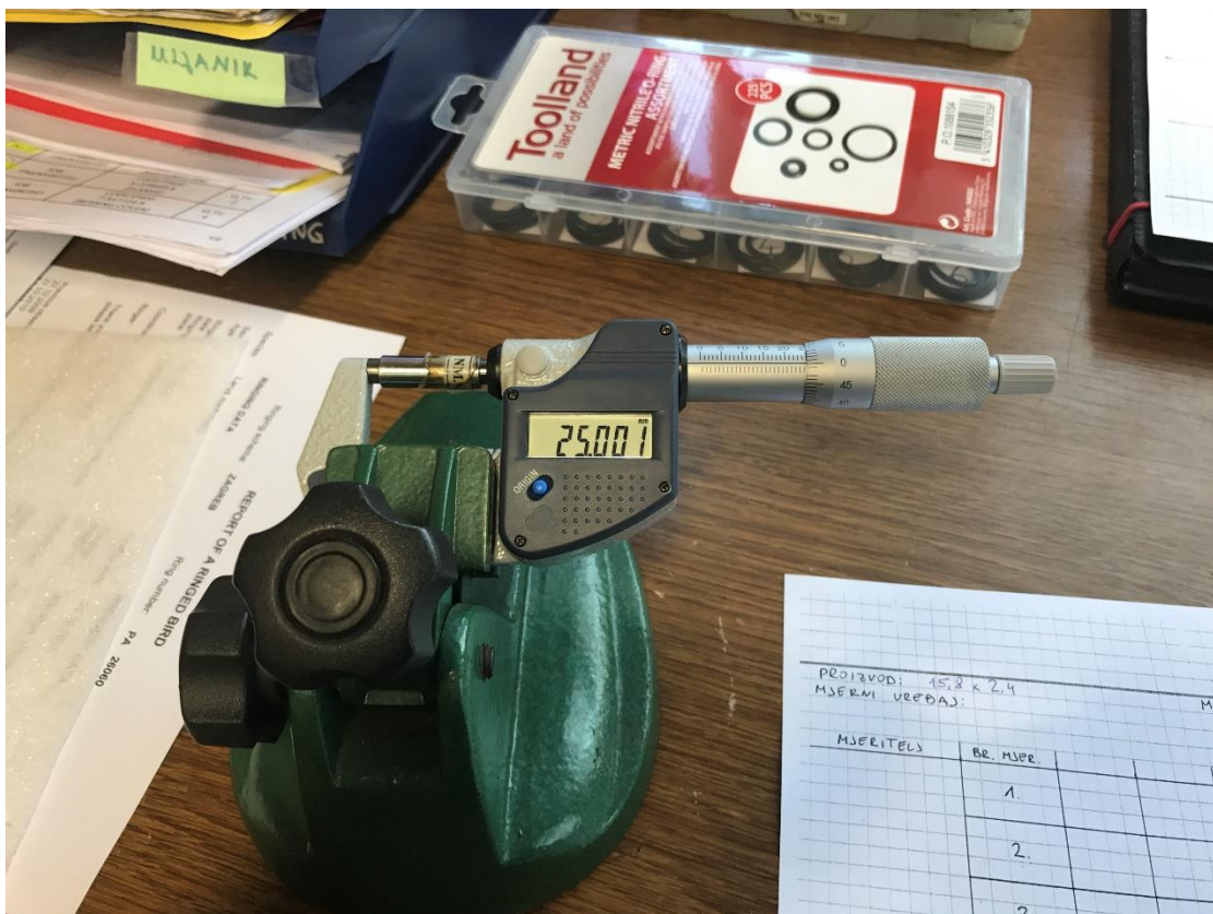
Slika 4.1. Kalibracija mikrometarskog vijka za vanjske mjere na početku mjernog područja
