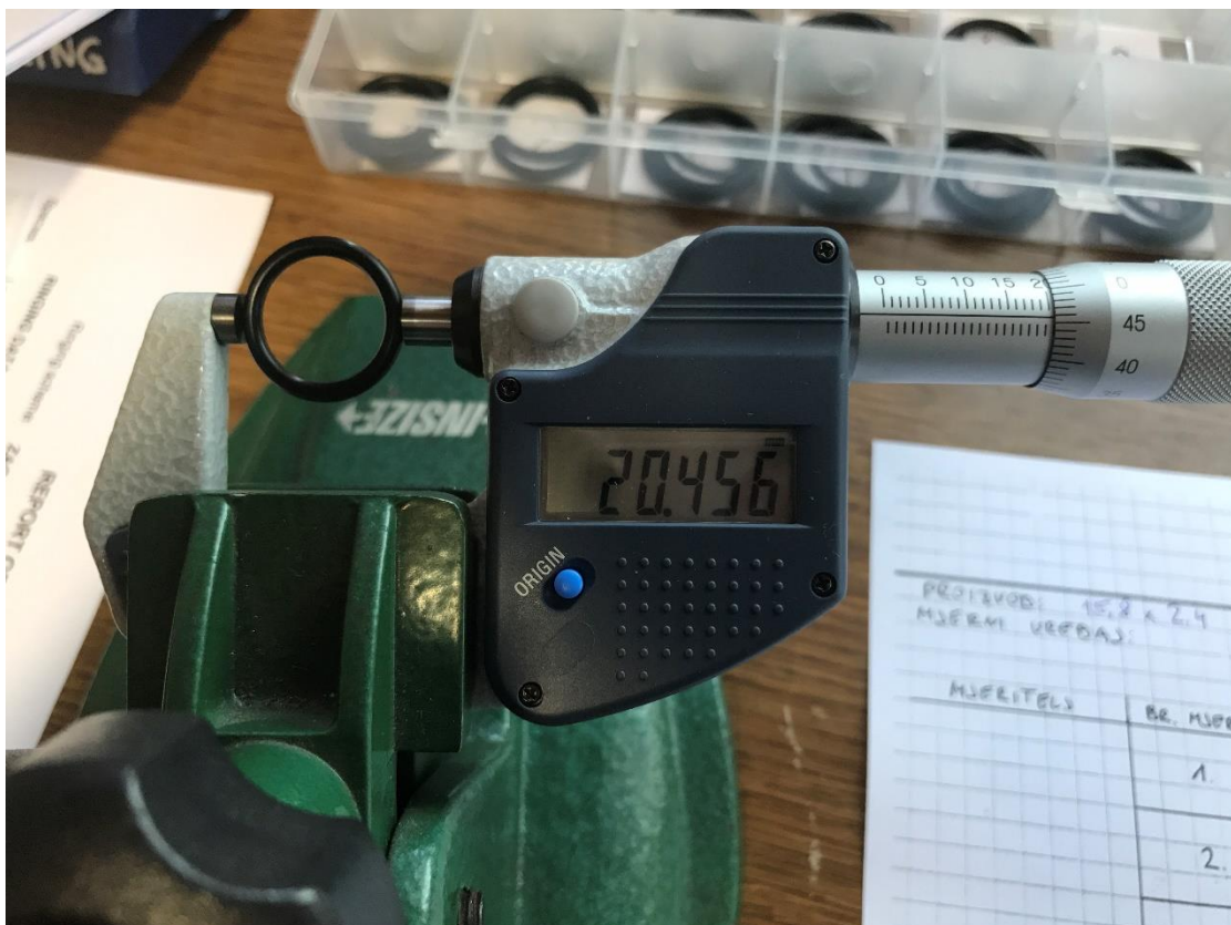
Slika 4.5. Primjer mjerenja vanjskog promjera O-prstena mikrometarskim vijkom
