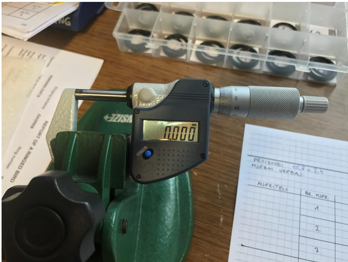
Slika 4.1. Kalibracija mikrometarskog vijka za vanjske mjere na početku mjernog područja
