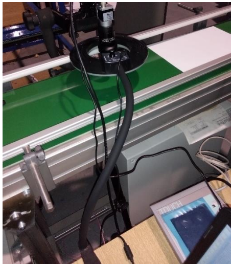
Slika 2.15. Učvršćivanje LED svjetiljke i postavljanje prstena oko kamere
