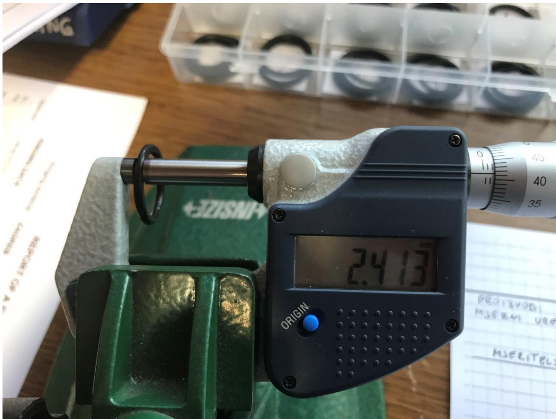
Slika 4.4. Primjer mjerenja poprečnog presjeka O-prstena mikrometarskim vijkom
