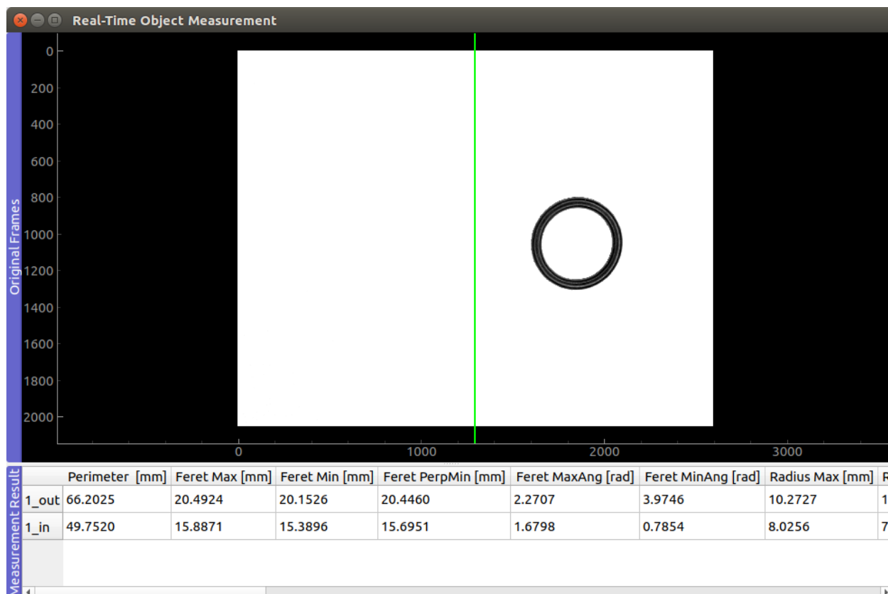
Slika 3.20. Prozor programske podrške s izvršenim mjerenjem jednog O-prstena
